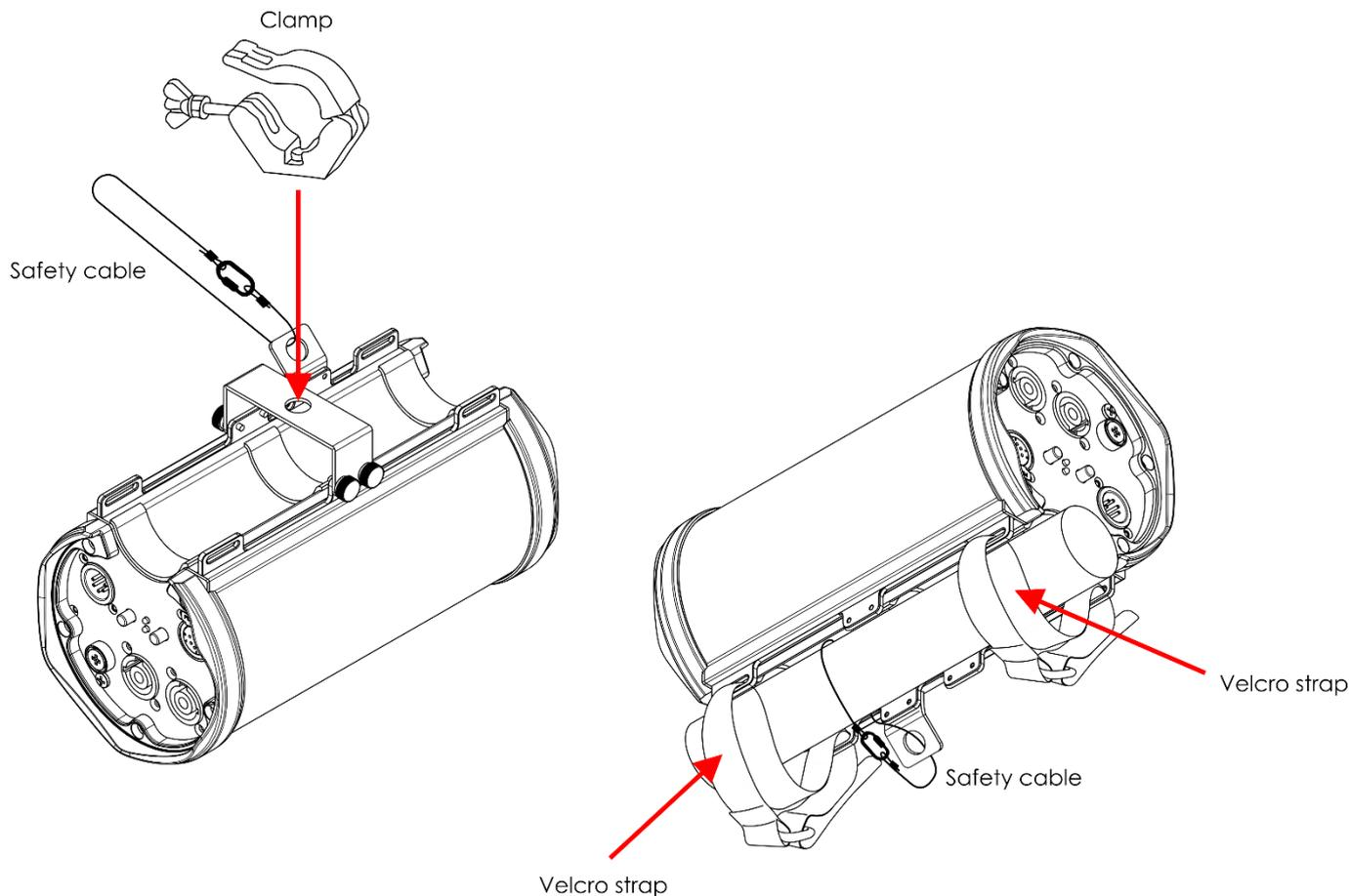
Der Truss Booster RDM 1-6 kann mit einer Schelle oder den mitgelieferten Klettbindern an jeder Art von Traverse befestigt werden.
