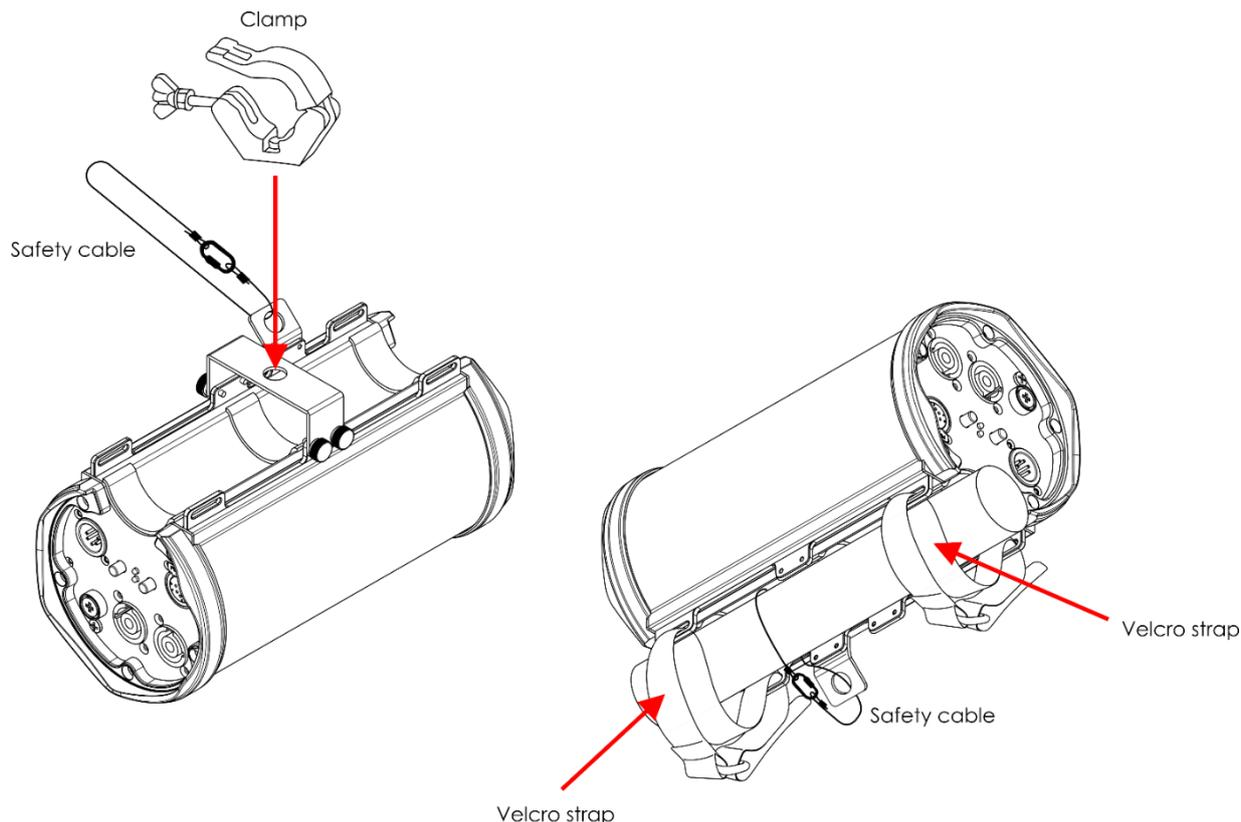
Il dispositivo Truss Booster RDM 1-6 può essere montato su qualsiasi tipo di traliccio con un morsetto o con le cinghie in velcro fornite in dotazione.
